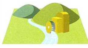
小水力発電 (単機出力1~1000kW以下)
